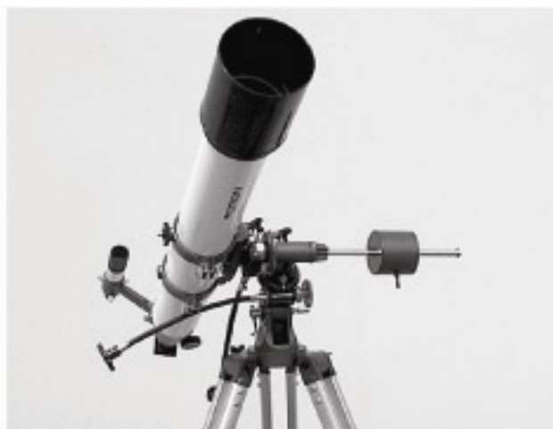
Рисунок 6б. Телескоп направлен на север
