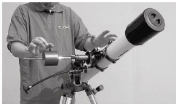
Рисунок 3б. Телескоп уравновешен вдоль оси прямого восхождения. Если отпустить руки, то стержень противовеса останется в горизонтальном положении
