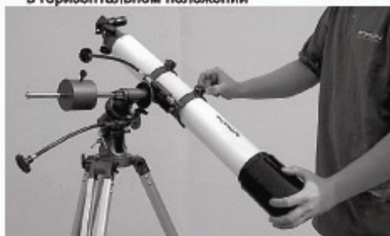
Рисунок 3д. Аккуратно уравновешивайте телескоп вдоль оси склонения. Как показано на рисунке, телескоп не сбалансирован (качается)
