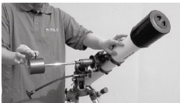
Рисунок 3а. Аккуратно уравновешивайте телескоп вдоль оси прямого восхождения, путем продвижения противовеса вдоль его стержня
