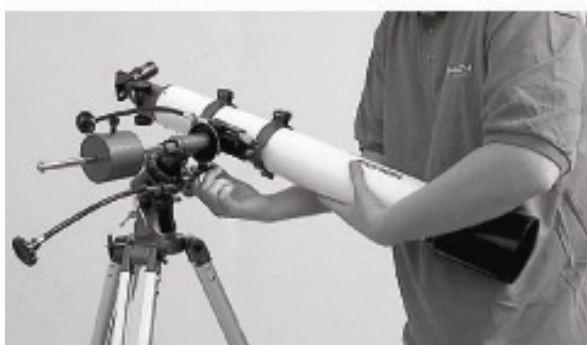
Рисунок 3с. Ослабьте ручку фиксации склонения для уравновешивания телескопа по оси склонения
