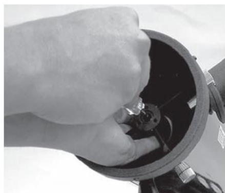
Рисунок 11. Для центрирования вторичного зеркала относительно гнезда окуляра, поворачивайте центральный винт крестовой отверткой, удерживая держатель зеркала пальцами. Не касайтесь поверхности зеркала
