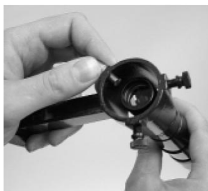
Рисунок 2б. Оттяните зажим и вставьте искатель в кронштейн, пока прокладка не попадет в кольцо.
