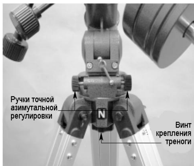
Рисунок 7. Для полярного выравнивания поверните штатив так, чтобы метка "N" в основании штатива, была обращена к северу. Ручки точной азимутальной регулировки предназначены для слабых смещений по азимуту.
