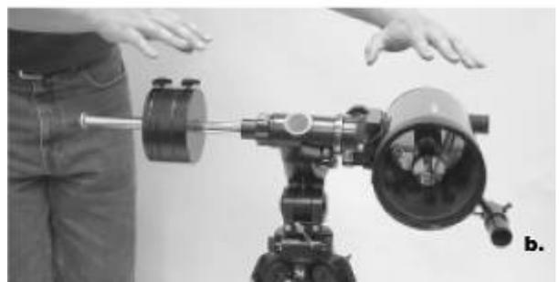
Рисунки 5а и 5б. Для правильной работы экваториальной монтировки необходима отбалансировать оптическую трубу на оси прямого восхождения (а). Ослабив ручку фиксации прямого восхождения, сдвигайте противовесы по стержню, до тех пор, пока они не уравновесят трубу (б). Если Вы отпустите обе руки, телескоп должен оставаться неподвижным.
