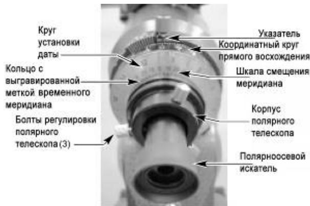
Рисунок 4. Полярноосевой искатель, установленный на оси прямого восхождения.
