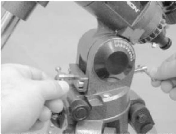
Рисунок 2. Для изменения угла широты экваториальной монтировки ослабьте один из регулировочных Т-винтов, затем затяните другой
