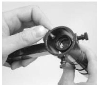
Рисунок 3б. Оттяните натяжитель и вставляйте искатель в кронштейн до тех пор, пока О-кольцо не окажется в кольце кронштейна
