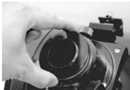
Рисунок 22б. Накрутите переходник к камере на фокусировщик.
