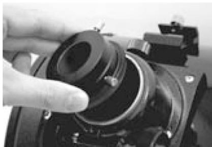
Рисунок 22а. Сначала снимите 1.25" и 2" переходники.
