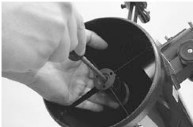
Рисунок 15. Для центрирования вторичного зеркала под фокусирующим, отрегулируйте центральный винт крестовой отверткой, удерживая пальцами держатель зеркала. Не касайтесь поверхности зеркала
