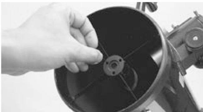
Рисунок 16. Отрегулируйте наклон вторичного зеркала, ослабляя или затягивая регулировочные винты 2 мм шестигранником.
