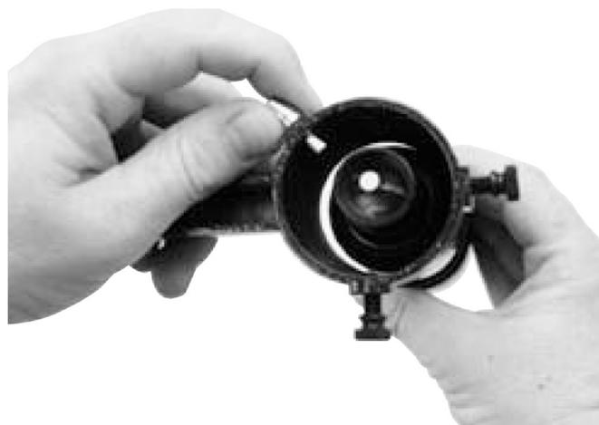
Рисунок 3б. Оттяните натяжитель и вставляйте искатель до тех пор, пока O-кольцо не окажется в кольце кронштейна.
