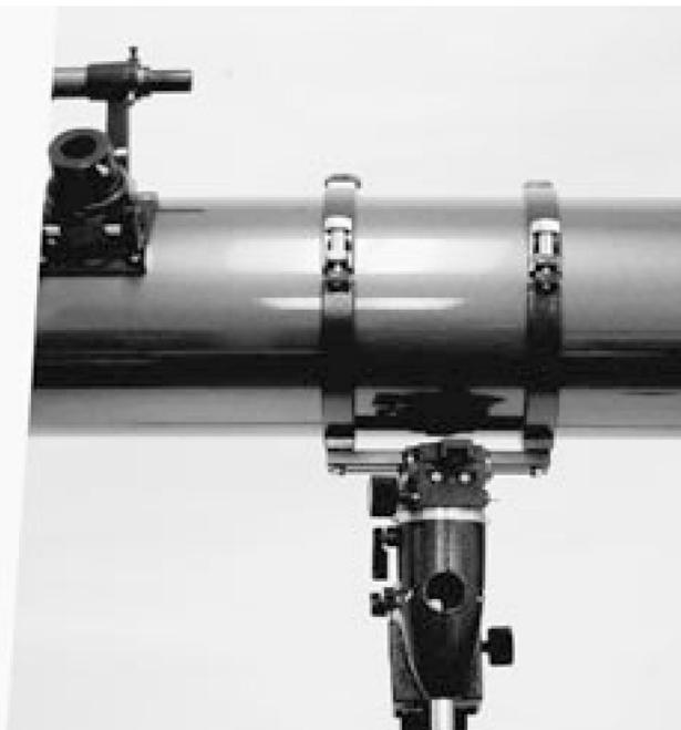
Рисунок 11. Для того чтобы смотреть в полярноосевой искатель, оптическая труба должна быть под углом  $90^\circ$  к оси прямого восхождения.
