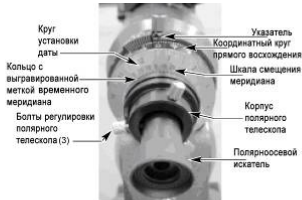
Рисунок 9. Полярноосевой искатель, установленный на оси прямого восхождения.
