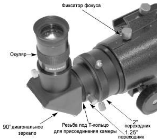
Рисунок 3. Фокусировщик телескопа-рефрактора AstroView 100
