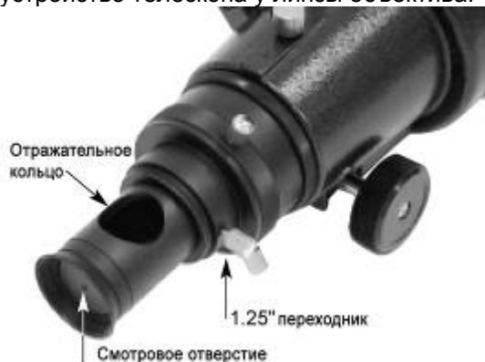
Рисунок 13. Устройство для коллимации в фокусирующей телескопа-рефлектора AstroView 100
