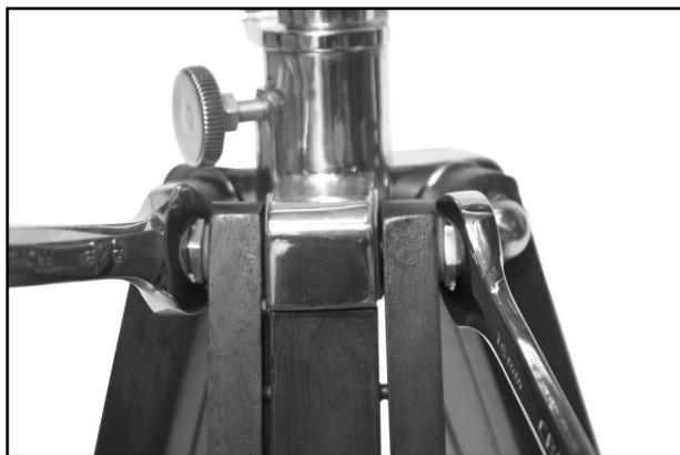
Рисунок 4. Затягивание глухих гаек двумя ключами.
